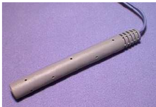
Rys. Czujnik światła CMA 0513. Budowa czujnika oparta jest o diodę Optrex p.n. OP555C mającą charakterystykę liniową. Pozwala na pomiar natężenia światła w zakresie 0.1 - 10 \text{ W/m}^2 , z dokładnością do 20 %. Zakres spektralny tego czujnika to 300-1100nm
