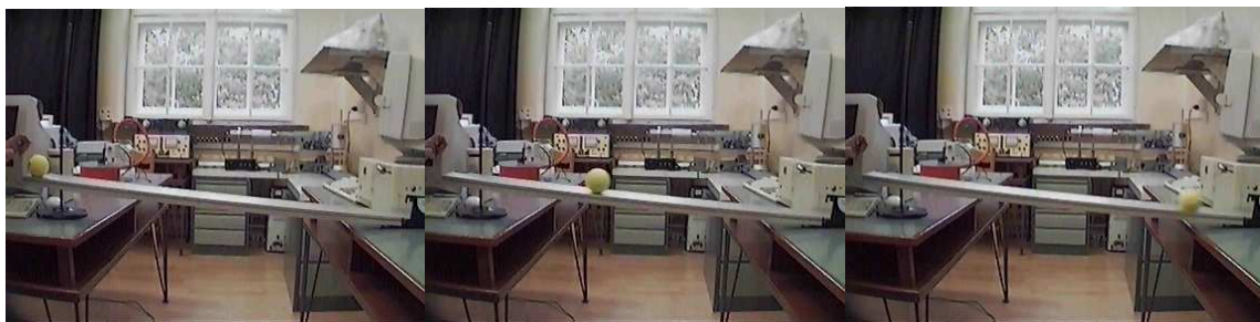
Rys. Kolejne fazy ruchu piłeczki na równi rejestrowane kamerą TV podłączoną do komputera.
