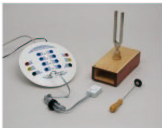
Rys.1. Sposób podłączenia czujnika dźwięku do konsoli pomiarowej.
