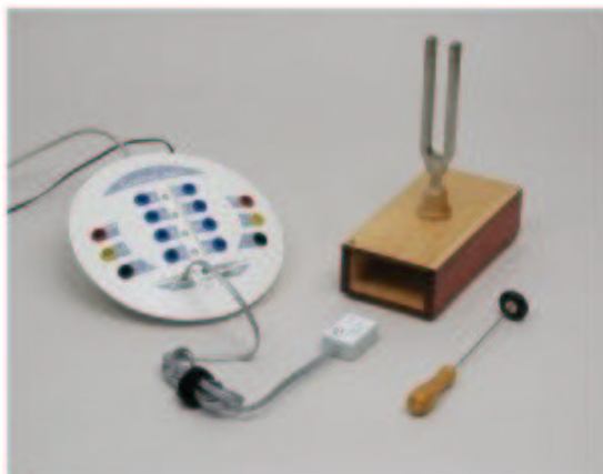
Rys.1. Sposób podłączenia czujnika dźwięku do konsoli pomiarowej.
