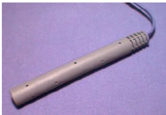
Rys. 1. Czujnik światła CMA 0513. Budowa czujnika oparta jest o diodę Optrex p.n. OP555C mającą charakterystykę liniową. Pozwala na pomiar natężenia światła w zakresie 0.1 - 10 \text{ W/m}^2 , z dokładnością do 20 %. Zakres spektralny tego czujnika to 300-1100nm
